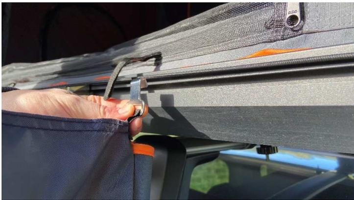
Außentasche für Schuhe in die Führungsschiene einführen
