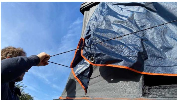
Das schwarze Spanngummi in die Führungsschiene der Bodenplatte einführen
