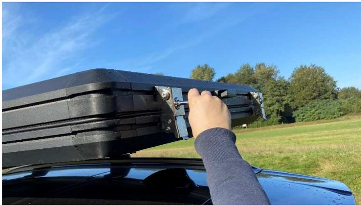
Die zwei Metallverriegelungen an der Boxenhinterseite mithilfe des Schlüssels öffnen
