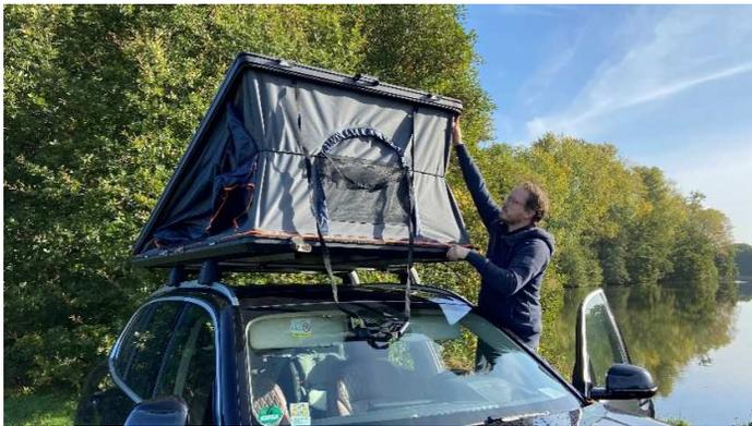
Durch die Unterstützung der Gasdruckfedern öffnet sich der Deckel dann von alleine.
