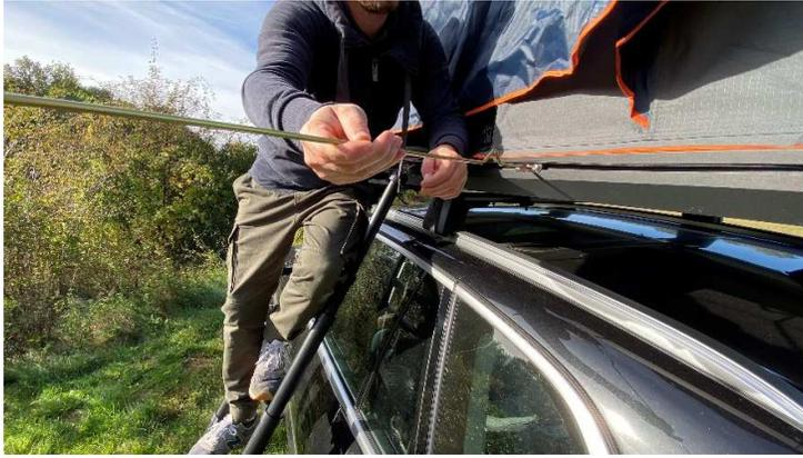
Die Abspannstangen für das Vordach aus dem Transportbeutel nehmen und in die zwei Löcher in der Bodenplatte an der Eingangsseite des Zelts einführen. Dabei darauf achten, dass die Stangen leicht schräg eingeführt werden
