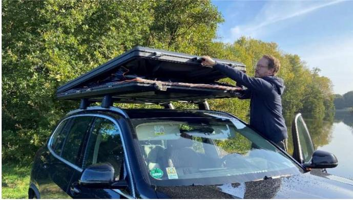
Zeltdeckel mithilfe des Handgriffs an der Vorderseite leicht anheben.
