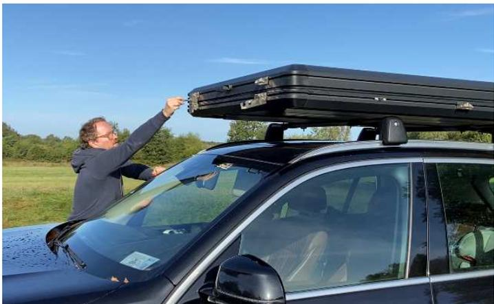
An der Vorderseite ebenfalls zwei Verriegelungen mit dem Schlüssel öffnen
