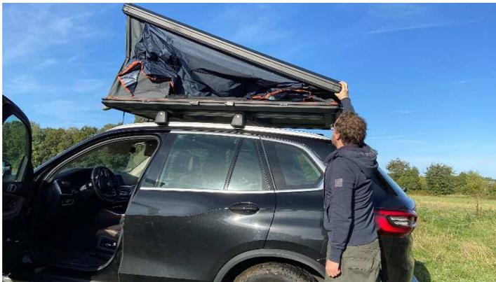
An der Rückseite ebenfalls leicht hochdrücken. Die Gasdruckfedern erledigen dann den Rest.
